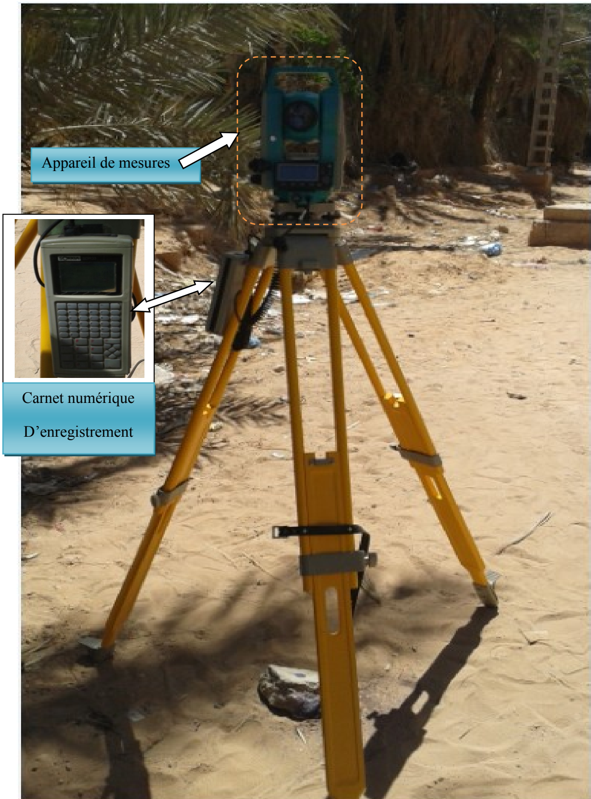
Photo V-1 : appareil de mesures avec Carnet numérique d'enregistrement
