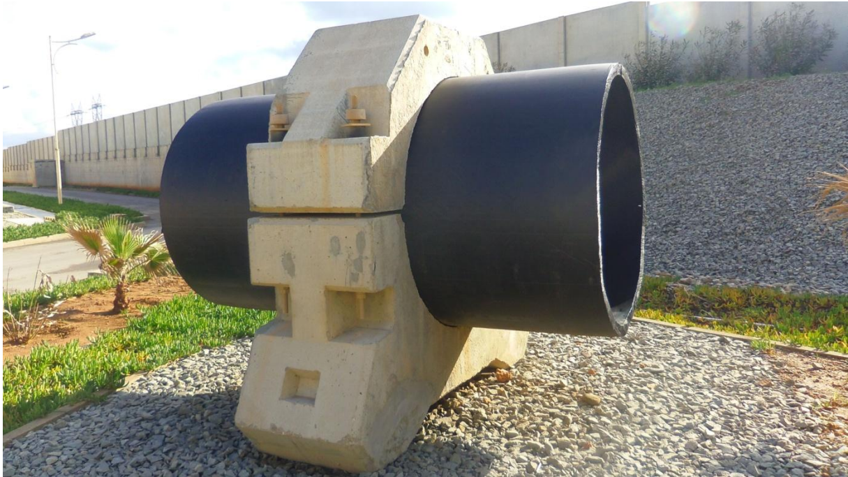
Figure II. 4: Conduite en PEHD.
