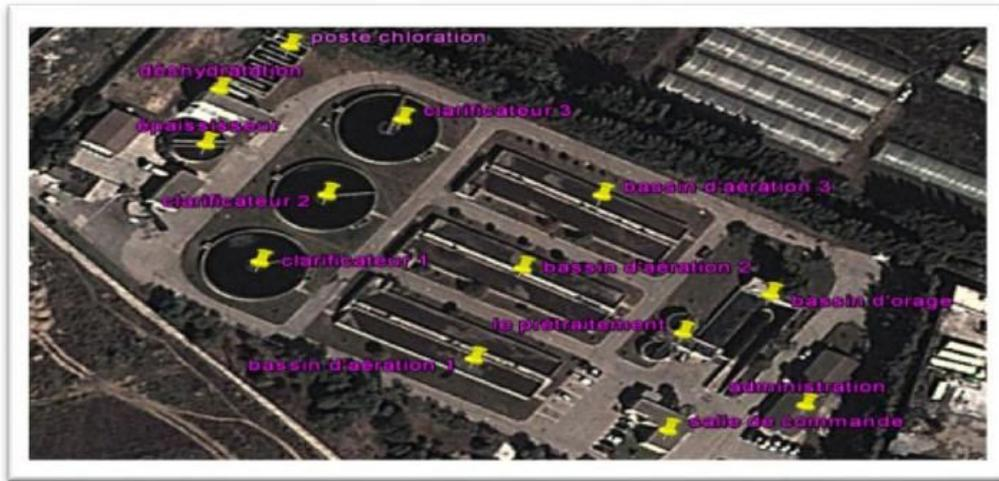
Figure III.2: Vue d'ensemble des ouvrages de la STEP de Boumerdes.
