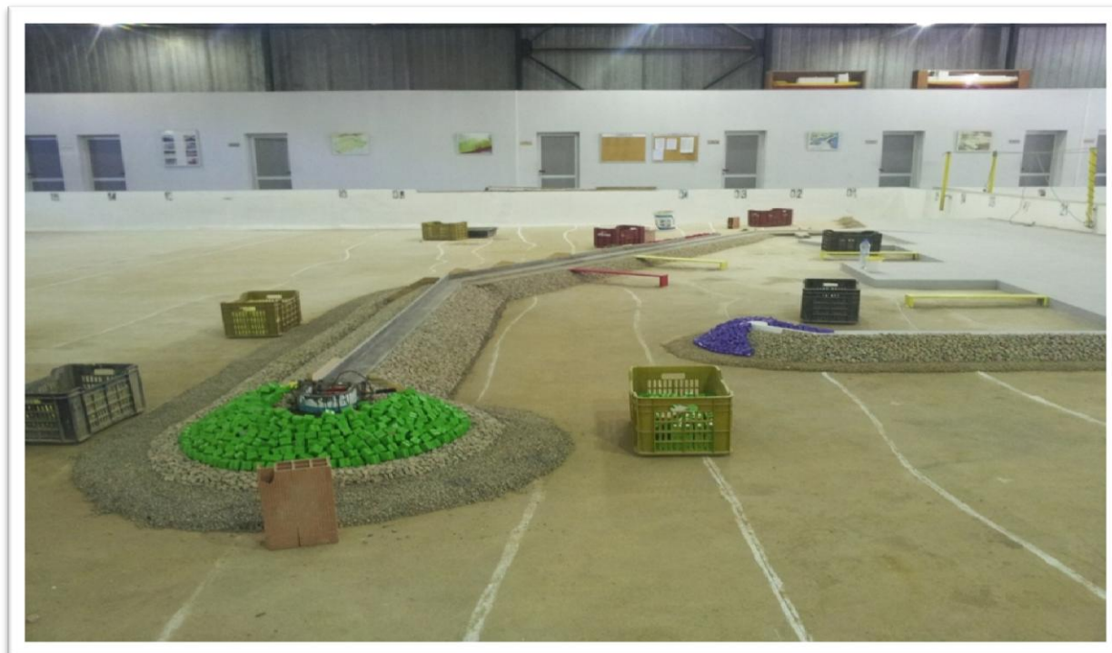
Figure VI.5 : photo montrant la mise en œuvre des ouvrages de protection selon les variantes retenues en canal à houle.
