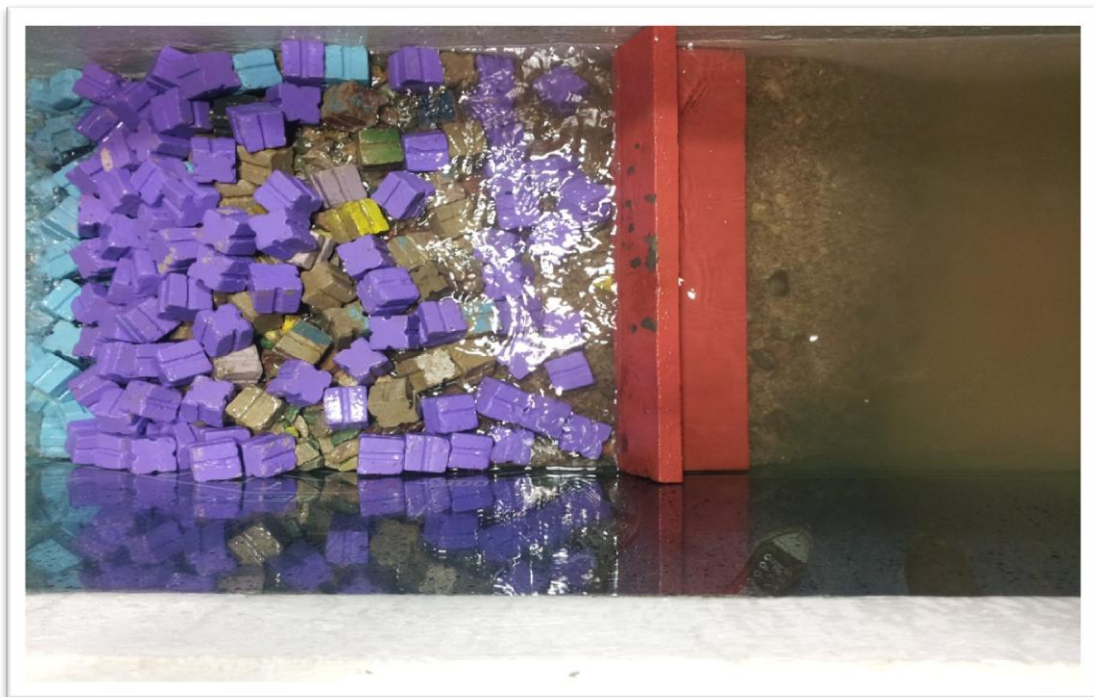
Figure V.7 : vue de dessus de la variante n°1 du profil B-B (les dégâts)
