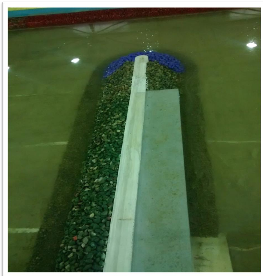
Figure VI.10 : photo montrant le redressement de la jetée secondaire du port de pêche étudié.
