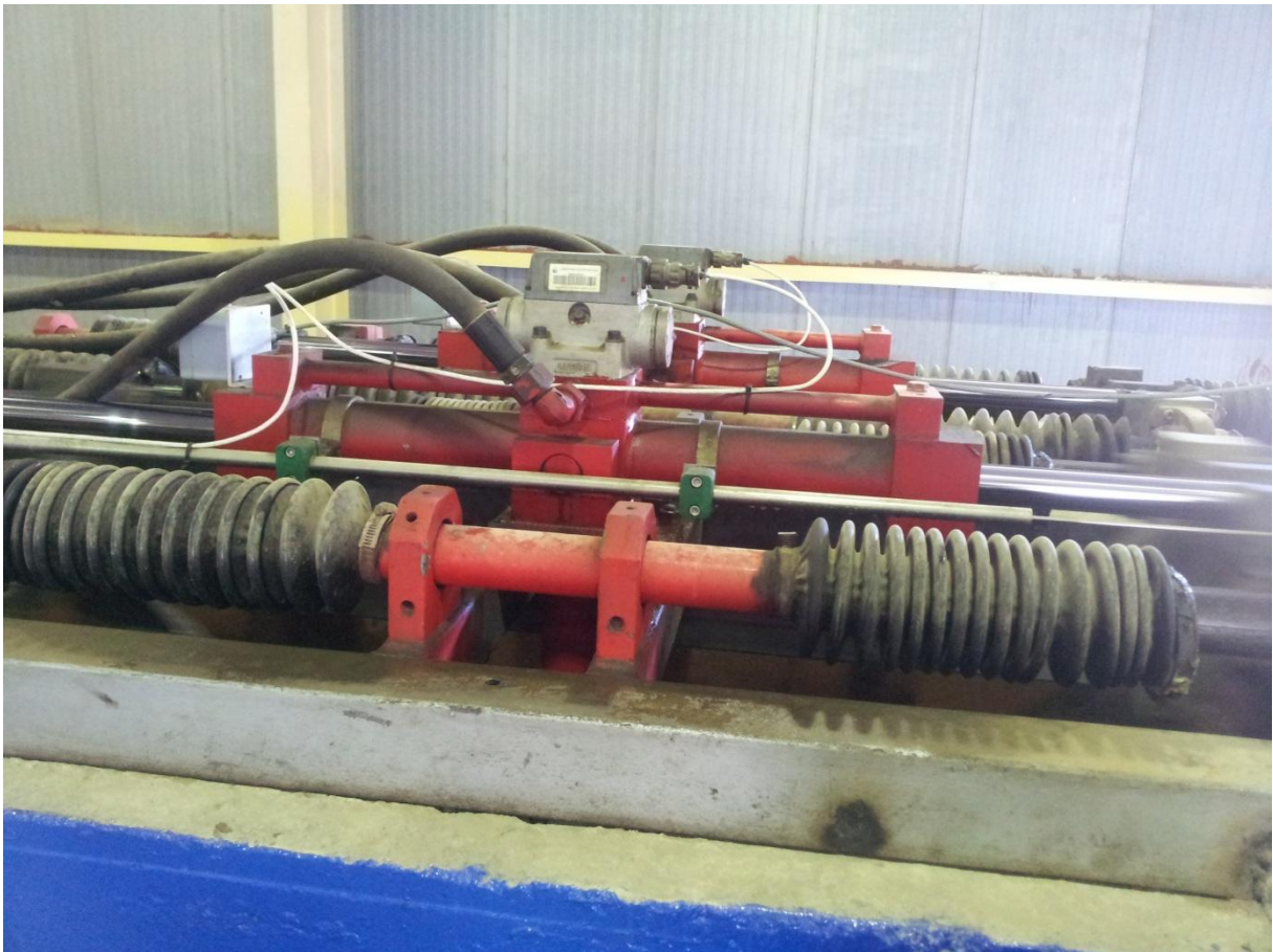
Annexe G: photo représentant le vérin hydraulique.
