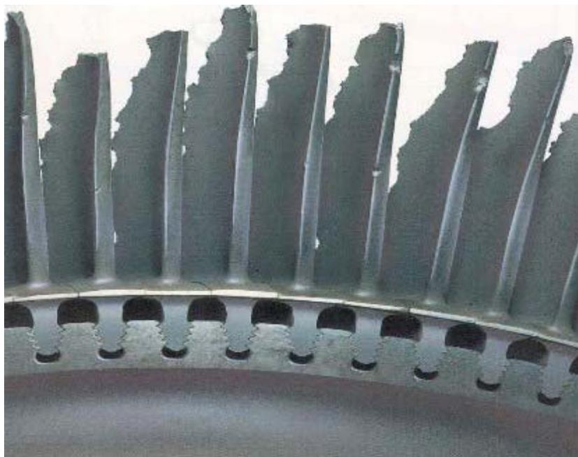
**Figure 2** : Destruction des aubages de turbine par sur -température
