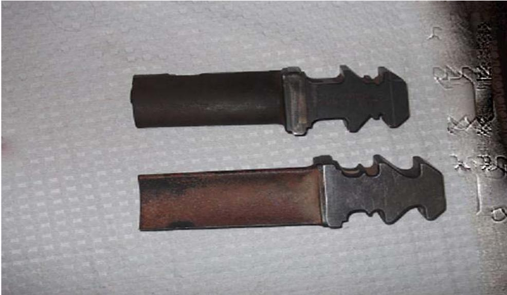
**Figure 17:** Les aubes de turbine à gaz TG 9D2 (usagée)
