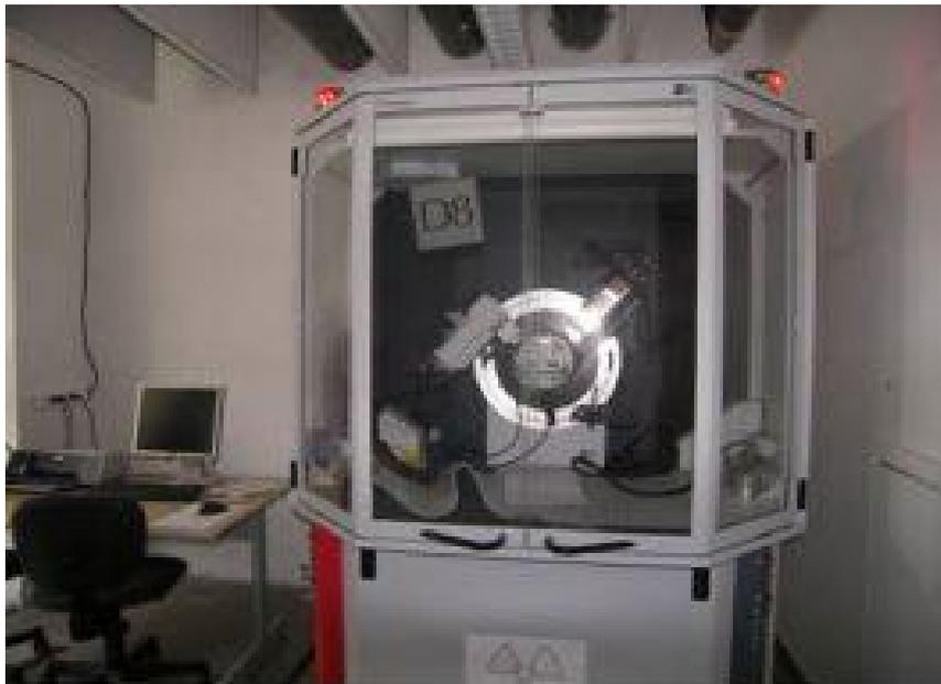
**Figure 30** : diffractomètre de type brunkers axs advanced (CDTA).
