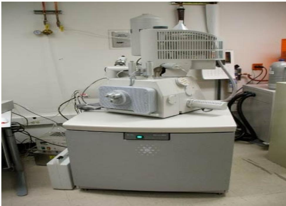
**Figure 23** : Photo du MEB de marque Quant A600 FEI.
