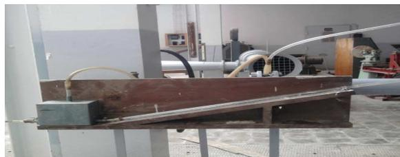
**Fig. IV-10:** Prises de pression au niveau de diaphragme
