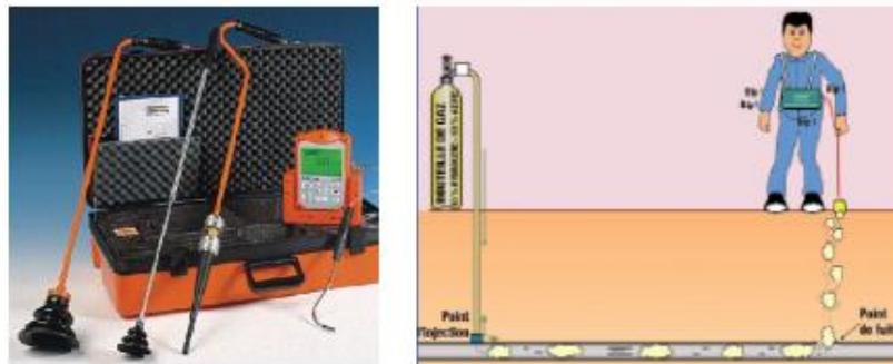
*Figure IV-7* : Principe de fonctionnement d'un Gaz traceur
