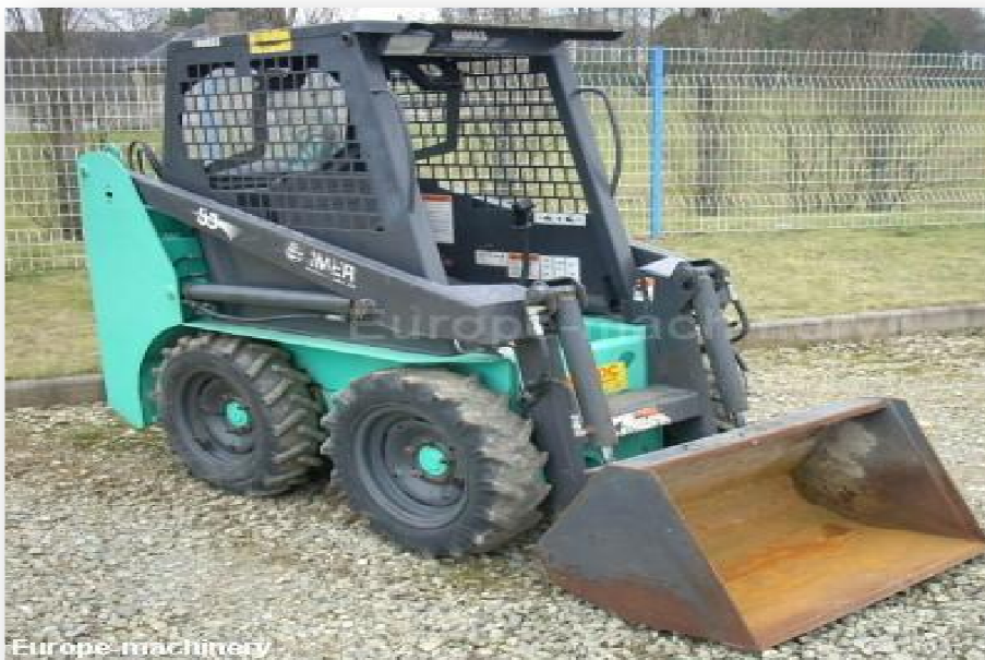
Photo III-10 : Mini engin de 0,9 m de largeur.
