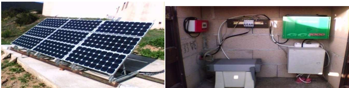
Fig. 4.4: Banc d'essai (générateur PV, onduleur et centrale d'acquisition de données).
