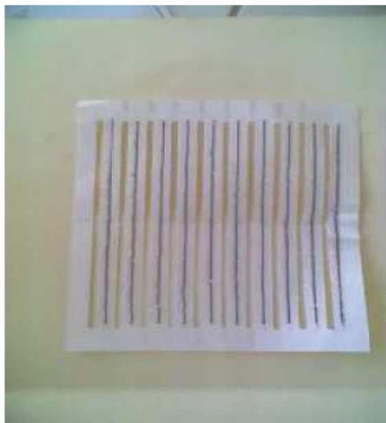
Figure N° 22 : Photo du filtre de fractionnement granulométrique après prélèvement.
