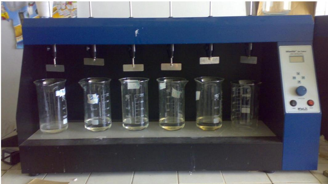
*Figure III-1 : Jar Test*
