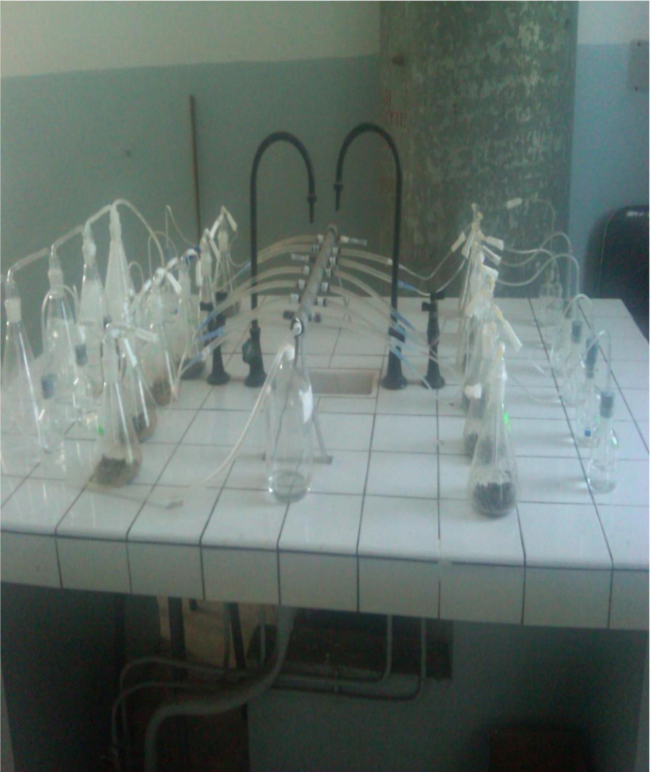
**Figure V.4** : Dispositif de respirométrie
