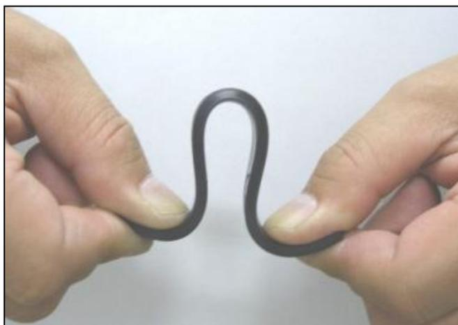
**Figure II.1** : Polymère développé à base d'huile de castor [25].
