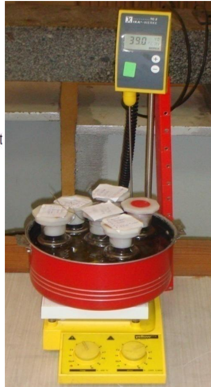
Figure V. 7. Schéma représentatif de l'installation expérimentale des essais de migration
