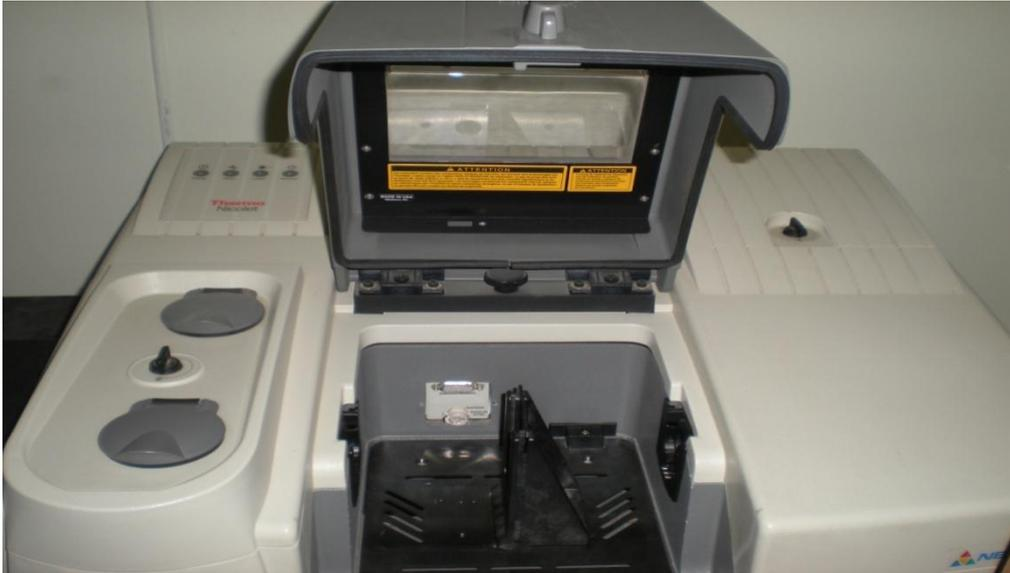
*Figure II.4 : Spectromètre Infrarouge à Transformée de Fourier.*
