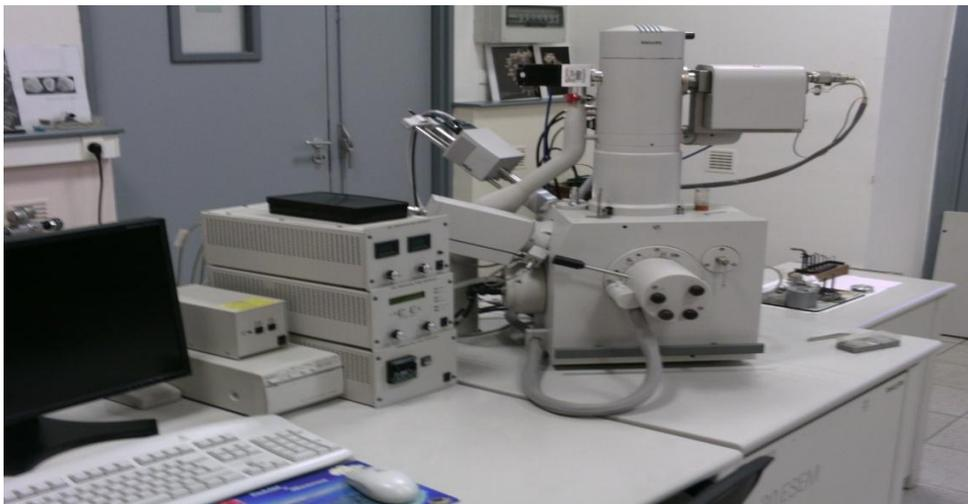
*Figure II.5 : Microscope électronique à balayage couplé à un analyseur élémentaire EDX.*
