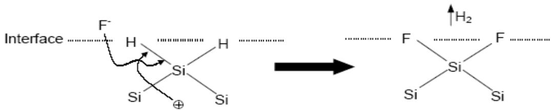
Figure I.2 : Mécanisme d'attaque de la couche de passivation Si-H par les ions  $F^-$  [15].
