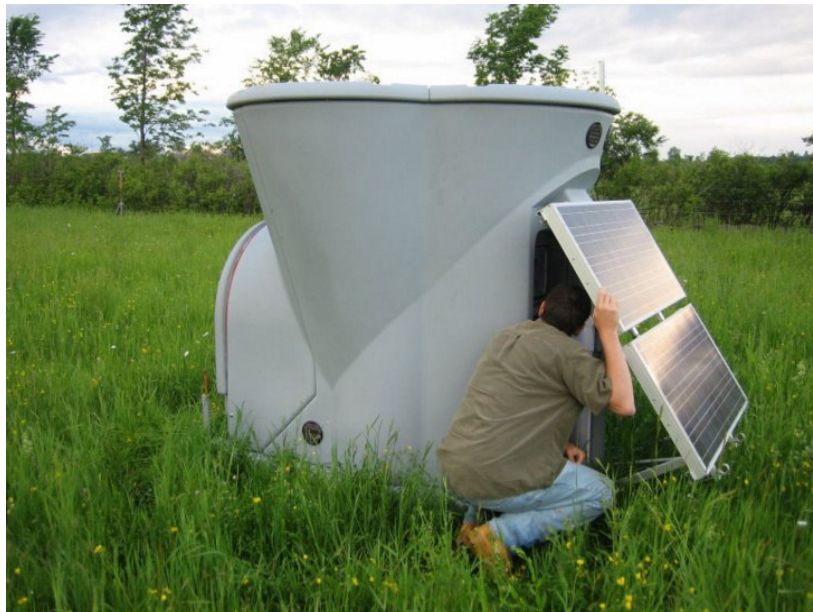
Fig. 1.22 Sodar TRITON portable de la compagnie Second Wind [24].
