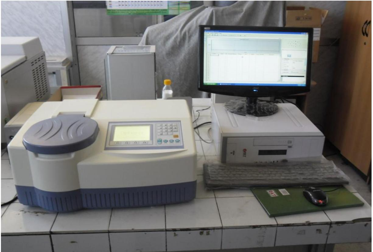
**Figure II.7** : spectrophotomètre utilisé lors de l'étude sur le réacteur de laboratoire
