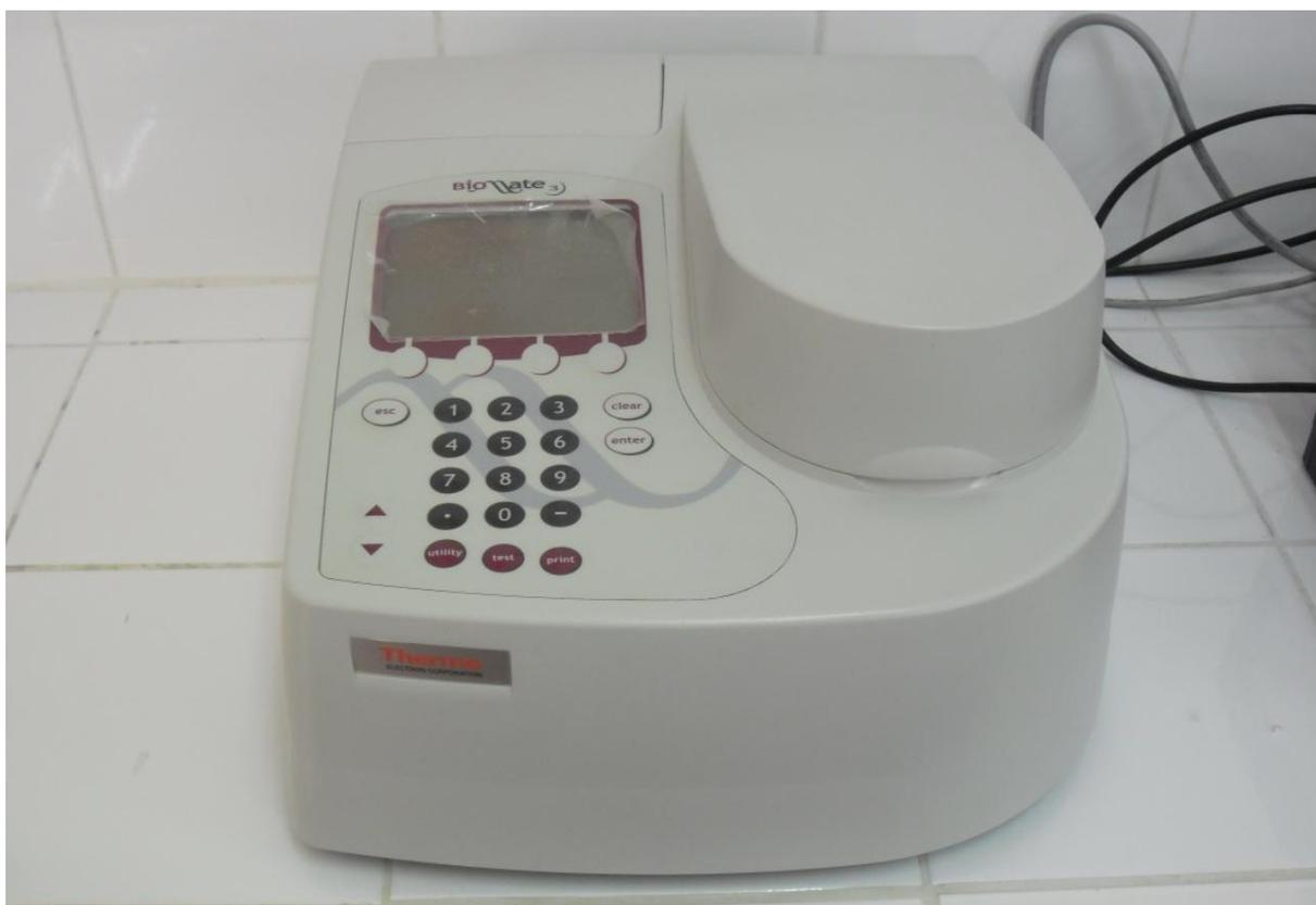
**Figure II.8 :** spectrophotomètre utilisé pour les analyses sur l'unité pilote
