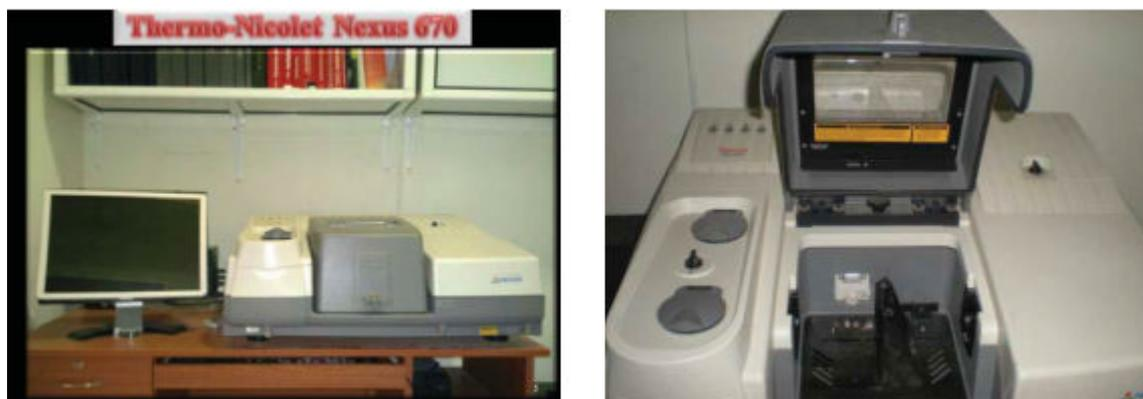
**Figure IV.3** : Spectromètre Infrarouge à Transformée de Fourier.
