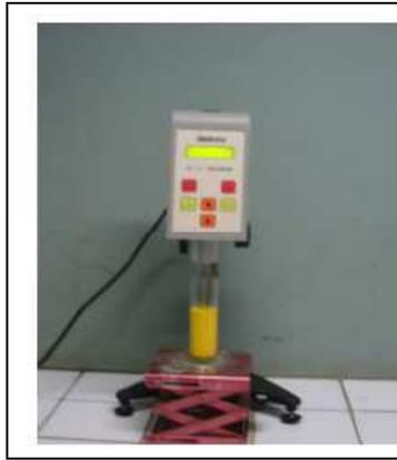
**Fig.18:** Rhéomètre de Brookfield (modèle DV-I+ viscosimeter)
