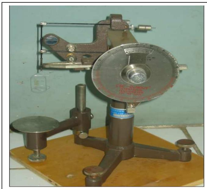
**Fig12** : Tensiomètre de Nouys de marque Central Scientific Co.
