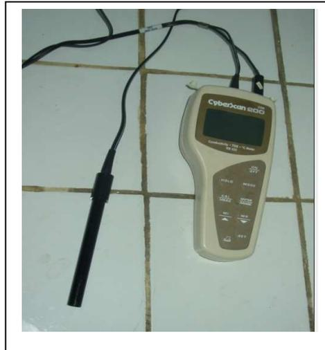
**Fig.14** : Conductimètre de marque Eutech, modèle Cyberscan CON 200.
