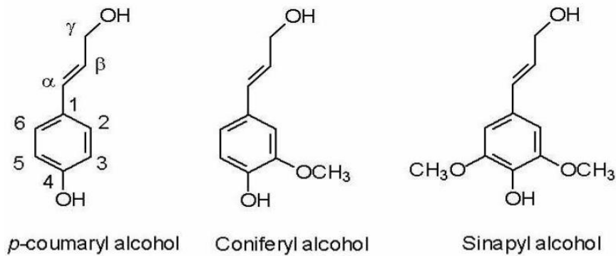
Figure 12 : Structure des précurseurs de la lignine [26].
