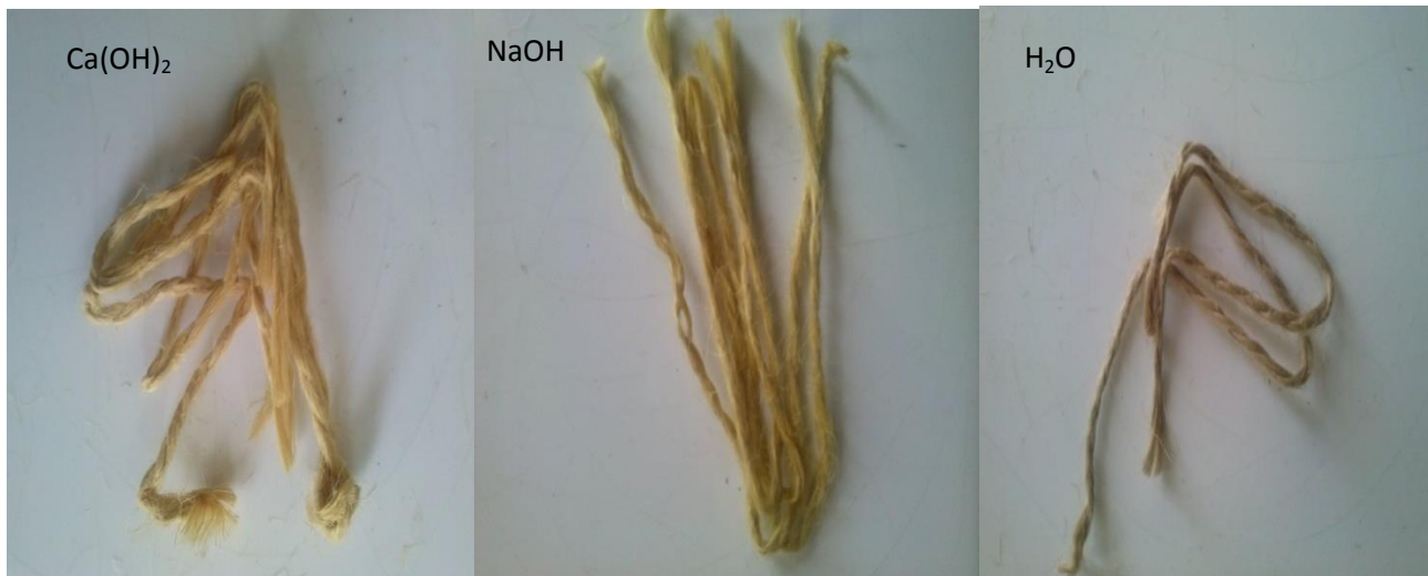
Figure 28 : Photos des fibres de jute après 60 jours de vieillissement dans différentes solutions.
