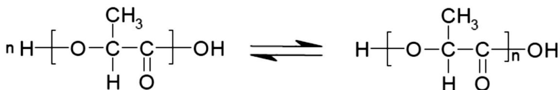
*Figure 1.4. Réaction de polycondensation d'acide lactique en acide poly lactique.*
