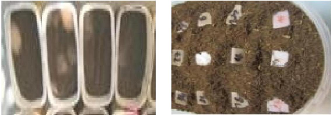
*Figure 5.4. La Biodégradation des échantillons dans le sol*
