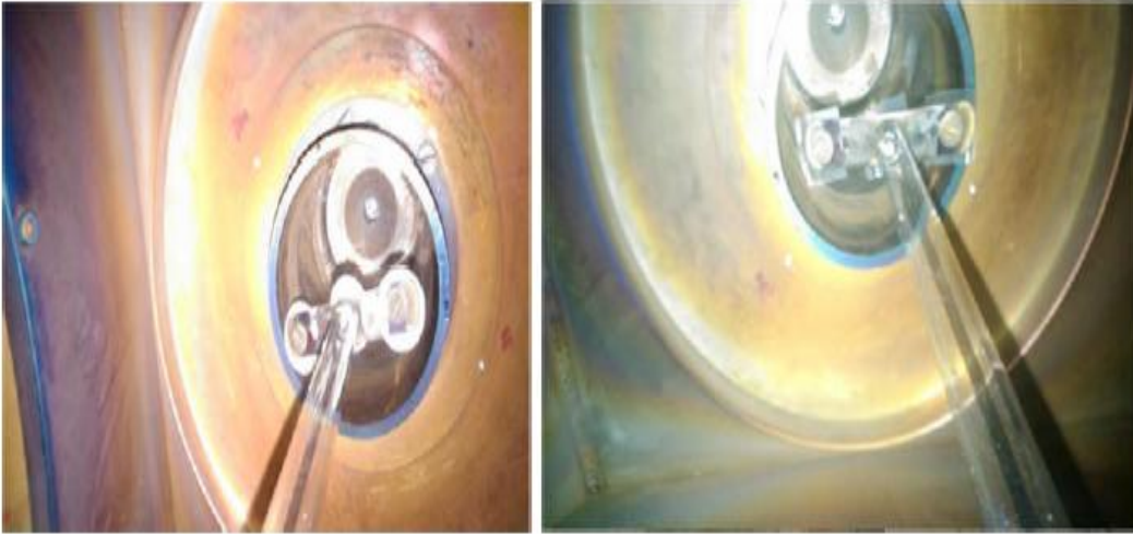
Figure 5.5: Emplacement des échantillons dans la chambre à vide avant d'être traités.
