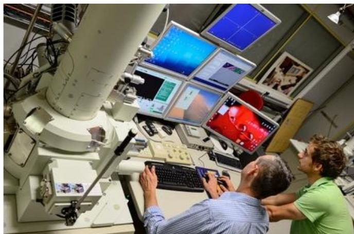
Figure 4-13: Microscope électronique à balayage JEOL JSM 7001F (ENSAM Campus d'Aix-En-Provence).
