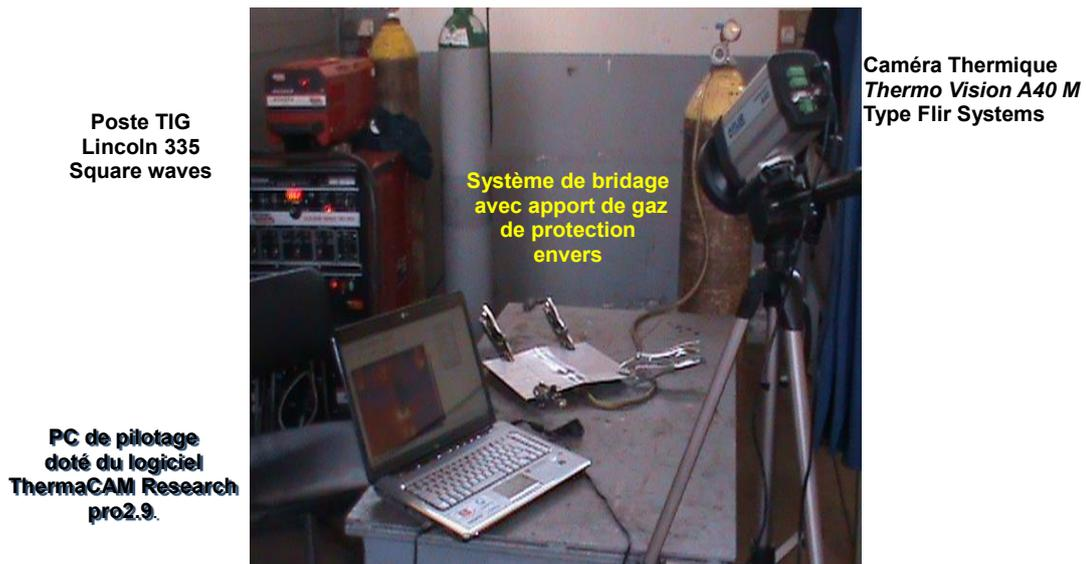
Figure 4-4: Dispositif expérimental du soudage TIG
