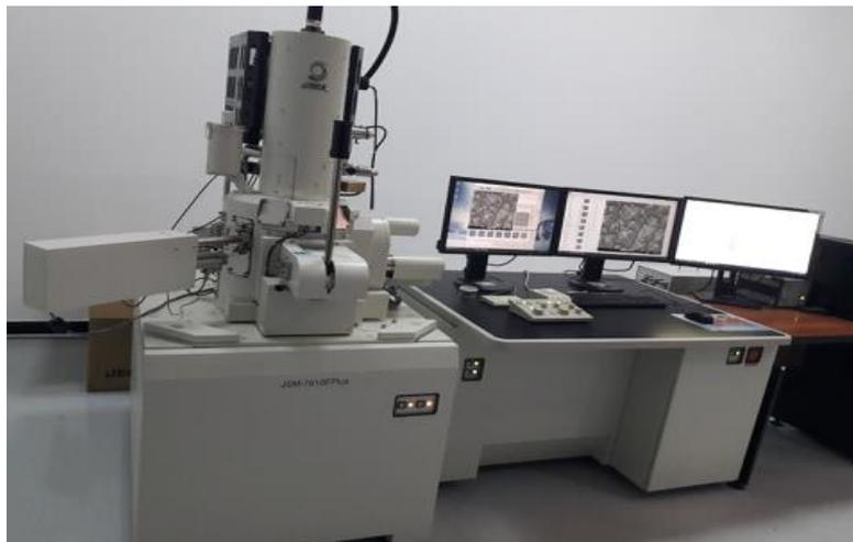
**Figure II. 3:** Photographie de l'appareil MEB équipé d'un détecteur EDS.
