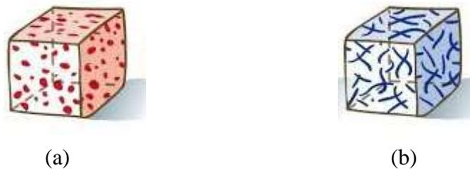
**Figure. I.1** Les classes de composites : a) composites à particules et, b) composites à fibres [4]
