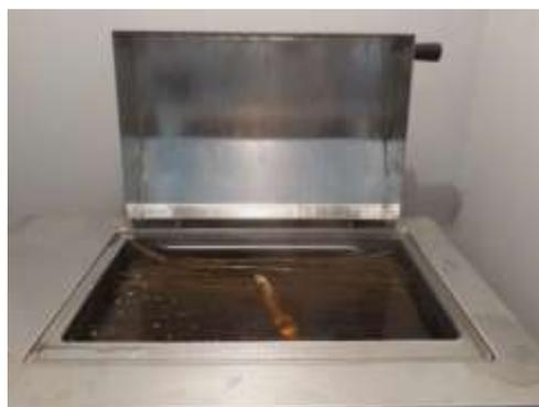
**Figure. II. 2** *Immersion des tiges d'Alfa dans le bain*
