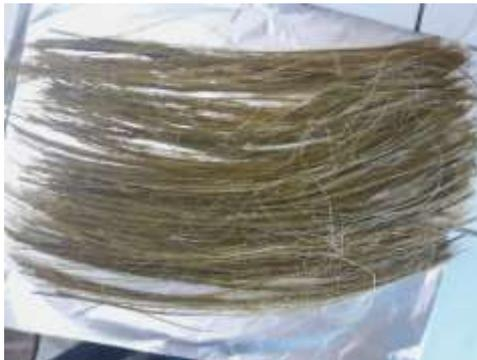
**Figure. II. 4** *Séchage des fibres d'Alfa*
