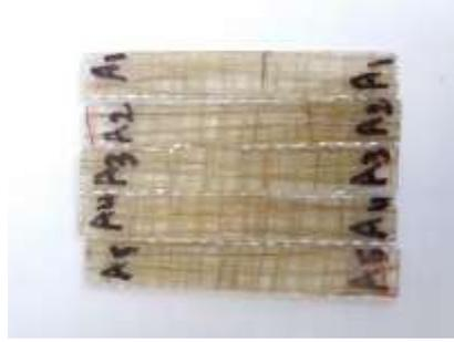
**Figure. II. 20** *Echantillon d'éprouvette en flexion*
