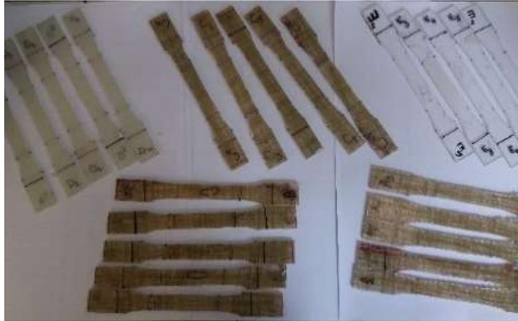
**Figure. II. 16** *Eprouvettes pour les essais de traction*
