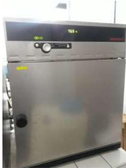
**Figure. II. 5** *Etuvage des fibres d'Alfa*
