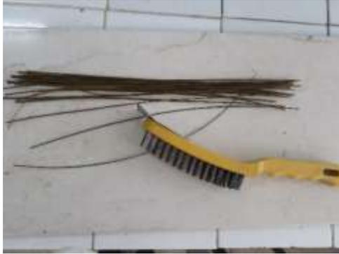
**Figure. II. 3** *Brossage des tiges d'Alfa*
