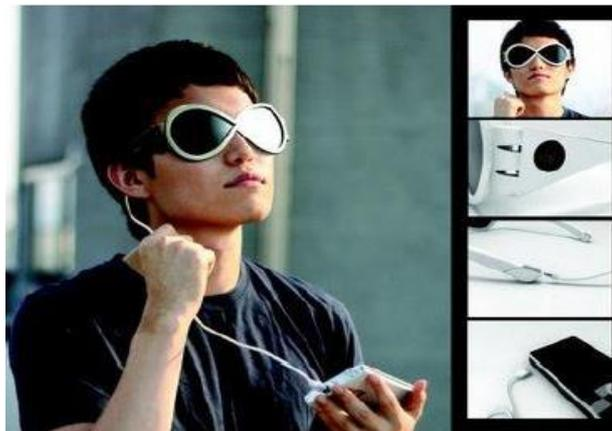
Figure I-15: Chargeur d'appareil mobile fonctionnant à l'aide de cellules Grätzel, incorporées dans des lunettes[37].
