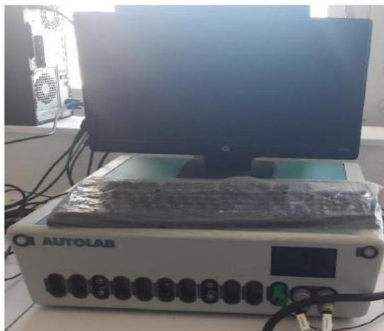
Figure II-2: : Potentiostat AUTOLAB.
