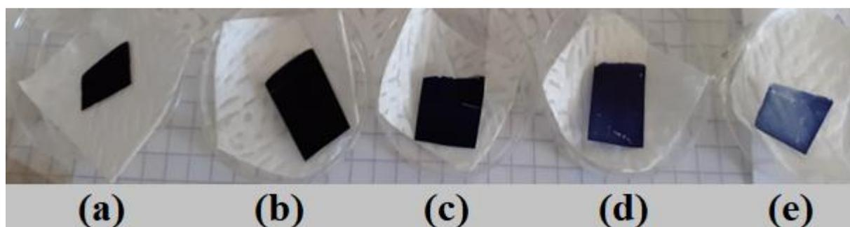
Figure III-28: Electrode de travail a plusieurs vitesses de balayage (a) :10mV/s ; (b) : 50mV/s ; (c) :100mV/s; (d):300;(e):600.
