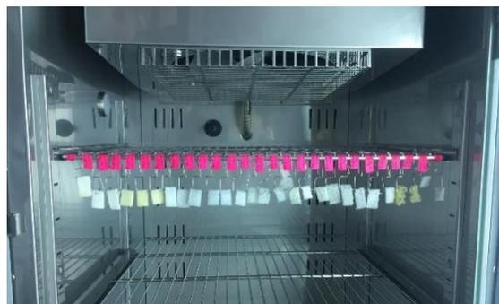
Figure 27 : Photo des échantillons de mousses dans l'enceinte de vieillissement accéléré
