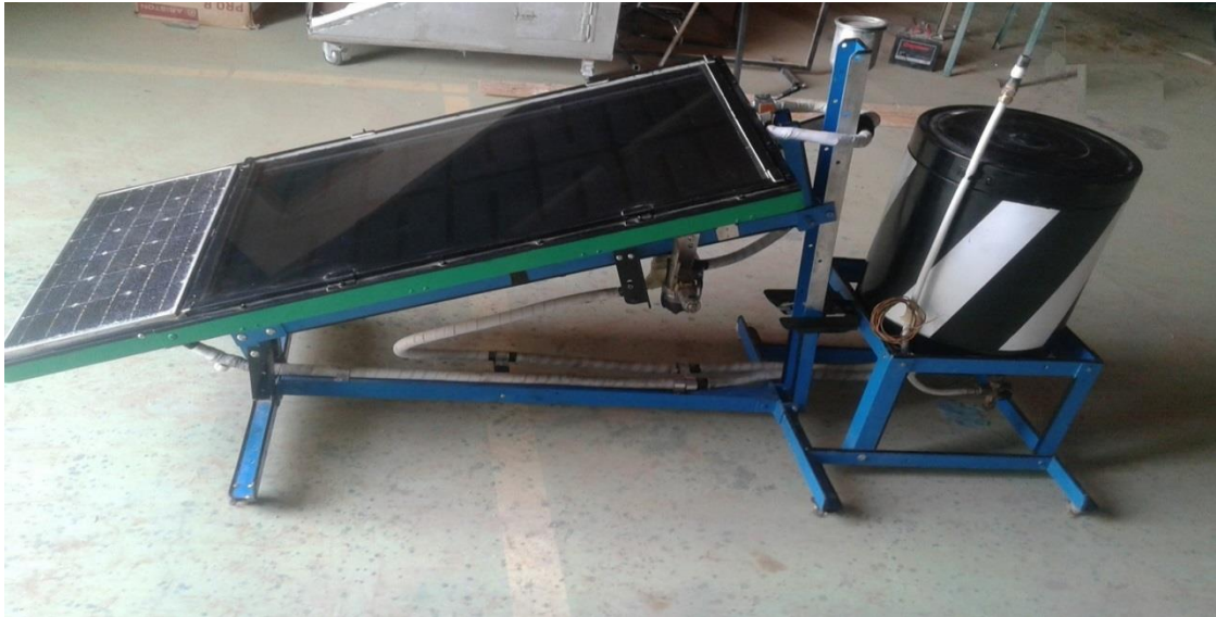
Fig. 3.3. Le prototype réalisé du chauffe-eau solaire développé [52].
