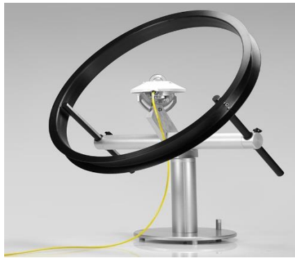
Fig. 2.4. Pyranomètre ombré pour la mesure du rayonnement diffus [35].
