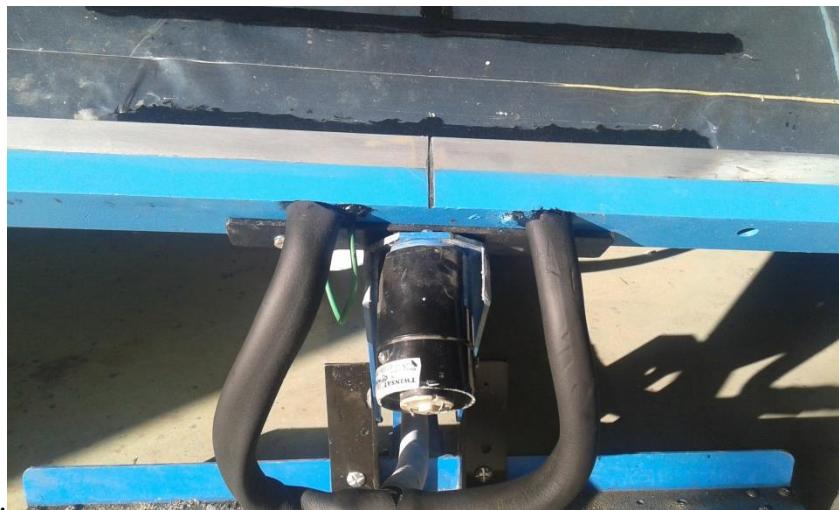
Fig. 3.8. Moteur électrique de suiveur solaire avec réducteur mécanique.
