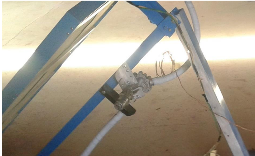
Fig. 3.6. La pompe à huile installée dans le prototype.
