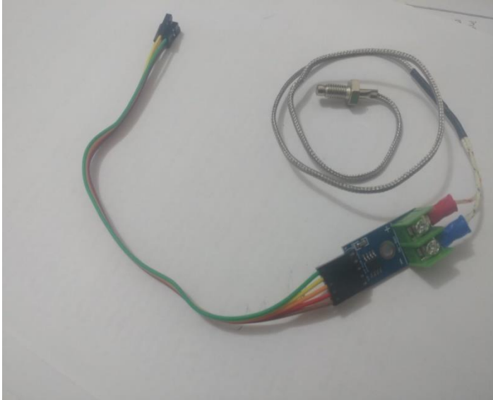
Fig 3.22 Capteur de température utilisé dans le prototype
