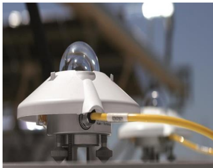
Fig. 2.5. Pyranomètre pour la mesure du rayonnement global [36].
