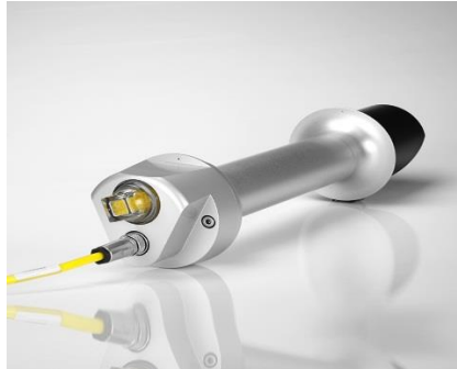
Fig. 2.3. Pyrhéliomètre pour la mesure du rayonnement direct [34].
