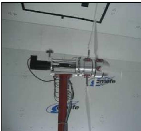
**Figure I.6 :** Prototype d'un système éolien à double rotor [RUD07].
