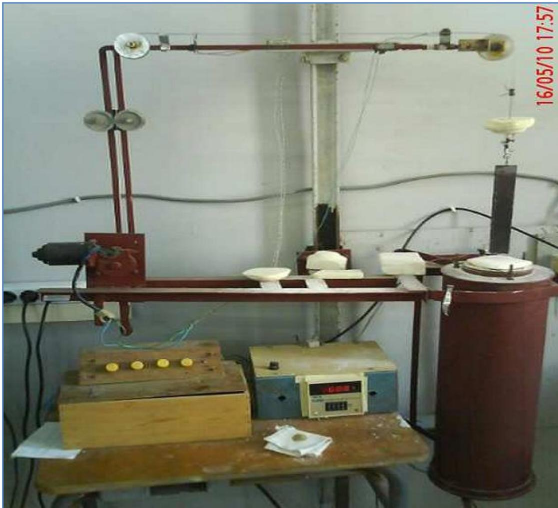
*Figure IV.6 : La phonographie du dispositif de la fatigue thermique utilisé.*
