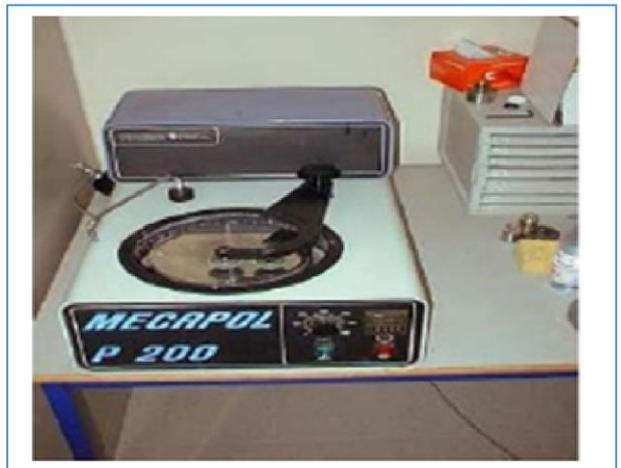
Figure IV.9 : Polisseuse de finition de type
