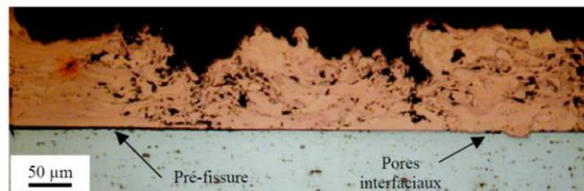
*Figure 1.22.* Coupe optique de l'échantillon la projection sous air à la pression atmosphérique ou APS ("Atmospheric Plasma Spraying") Epaisseur du dépôt 130 µm ASTM 2017 /Cu
