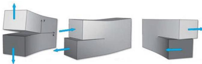
*Figure 2.6. Les trois modes de rupture.*
