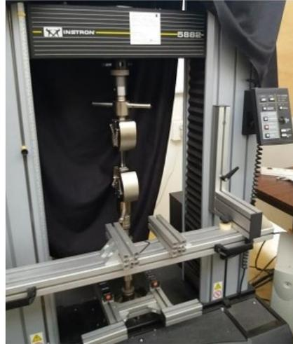
**Figure 3.9** Machine de traction-compression électromécanique «INSTRON 5882»
