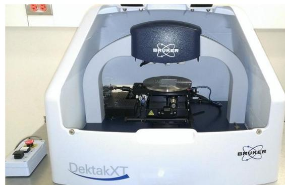
**Figure 3.2.** Profilomètre mécanique DektakXT® (Bruker).
