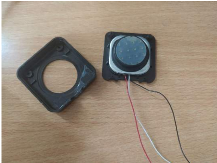
Figure 3.7 Supports 3D pour la fixation des cellules de charge sur la plaque de balance.
