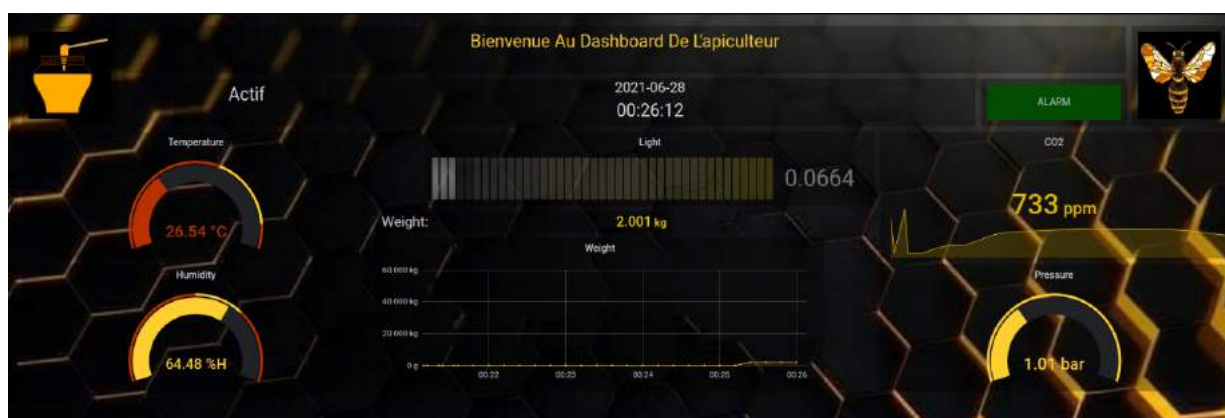
Figure 6.6 Visualisation du dashboard suite à l'ajout d'un poids de 2 Kg.
