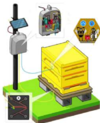
Figure 2.6 Illustration du système de la ruche connectée.
