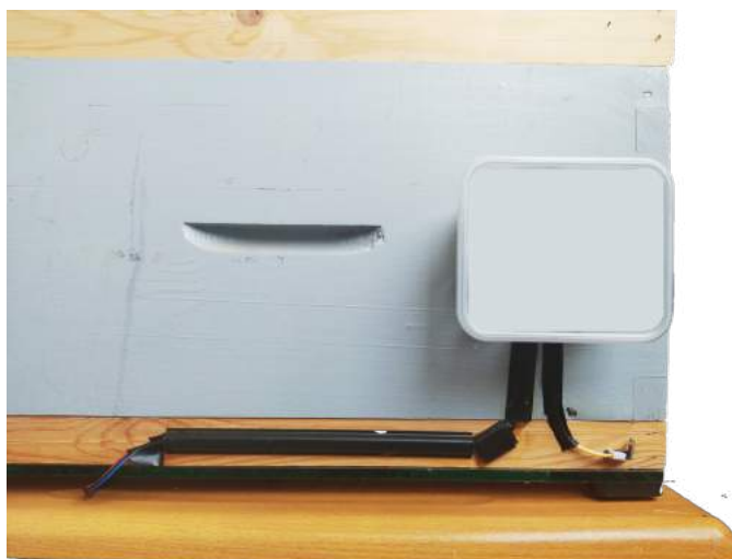
Figure 3.25 Emplacement du capteur de lumière.
