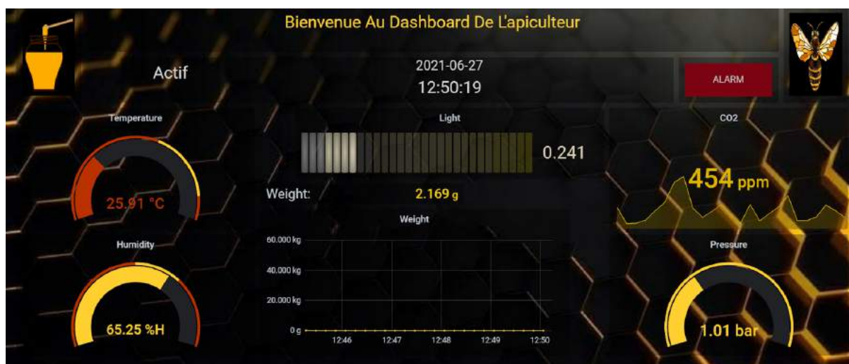
Figure 5.17 Dashboard de l'apiculteur réalisé sous Grafana.
