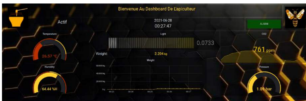
Figure 6.7 Visualisation du dashboard suite à l'ajout d'un poids de 2 Kg et 200 g.
