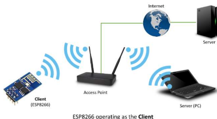
Figure 4.13 Établissement d'un client WiFi au niveau de l'ESP 01s.
