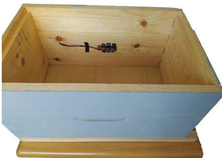
Figure 3.24 Emplacement des capteurs de température/humidité, pression et taux de CO2 à l'intérieur de la ruche.
