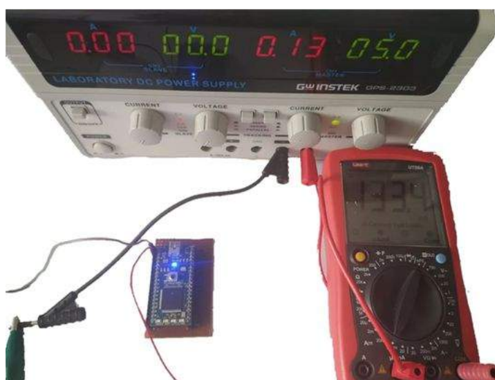
Figure 2.11 Mesure du courant consommé par la carte MBED LPC1768 après optimisation.
