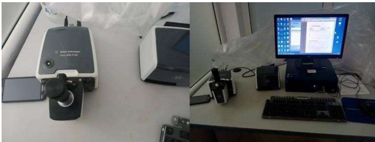
Figure 33 : Image correspond au FT-IR de Universal Lab de type Agilent technologie CARRY 630 FTIR
