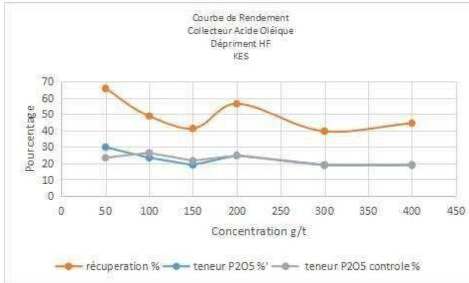
**Figure 28: Courbe de rendement et de récupération; collecteur acide oléique déprimant HF KES.**
