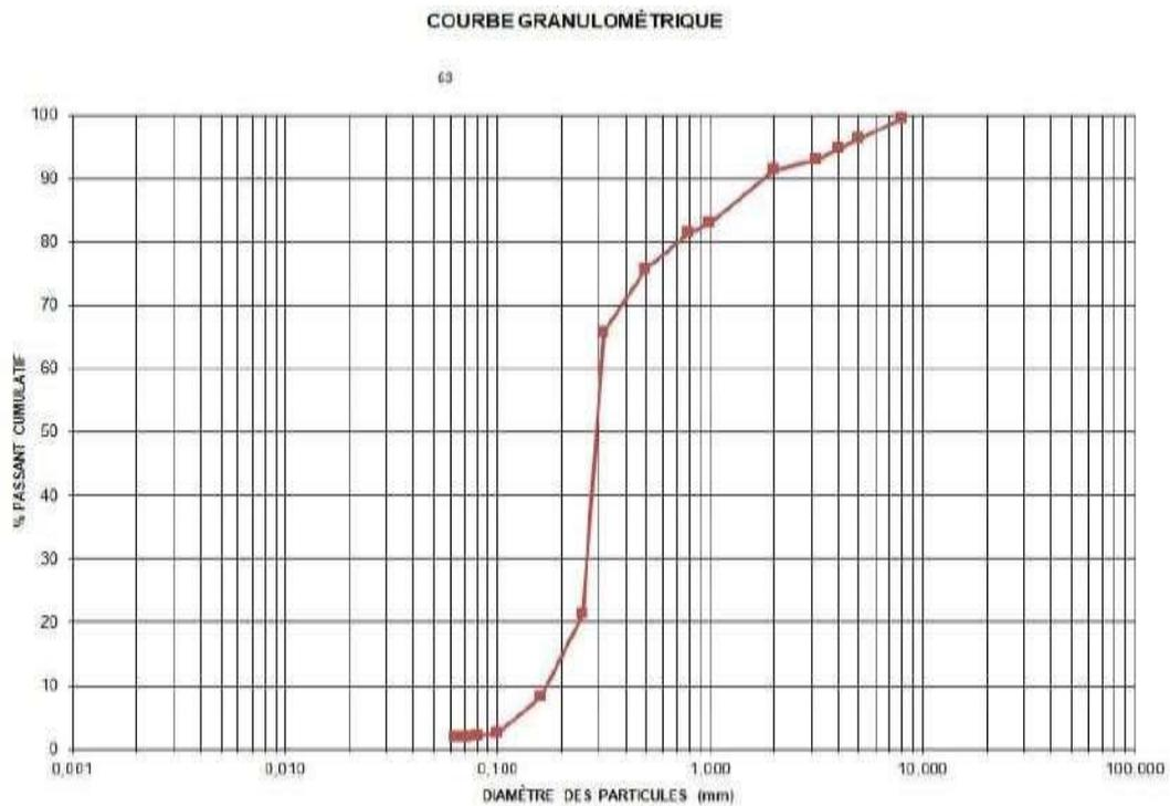
**Figure 17 : Courbe granulométrique de l'échantillon du phosphate de KES.**
