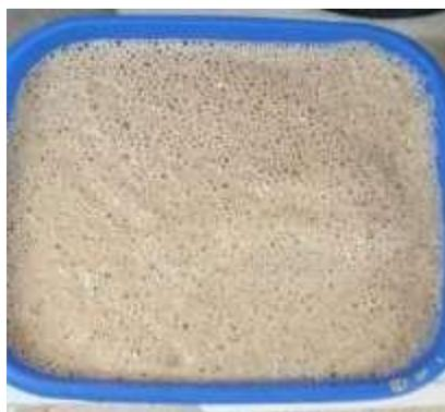
**Image 07 : Résultat de la flottation en utilisant le dodecylsodium de sulfate comme collecteur**
