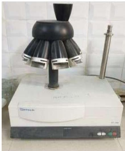
**Image 02: Diviseur d'échantillons modèle PT 100 Retsch.**
