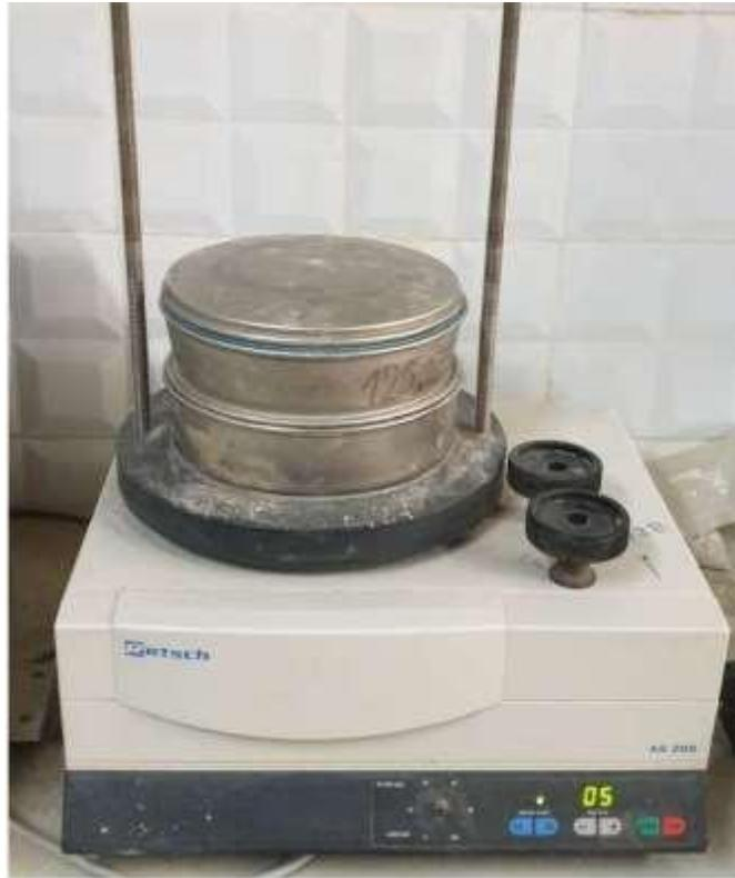
**Image 03: Tamiseuse électrique de la marque Retsch modèle AS 200.**
