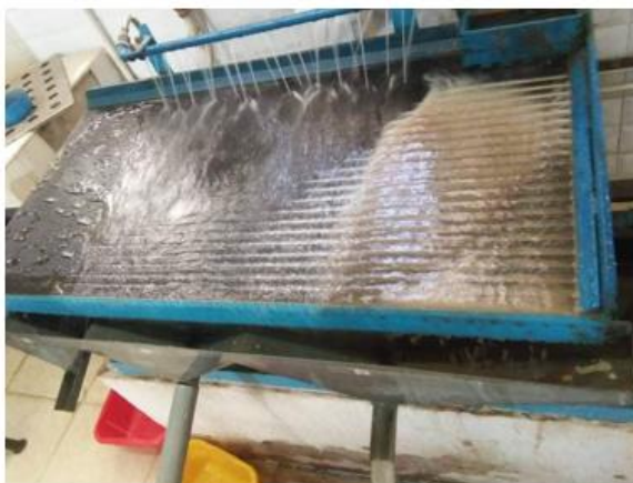
Figure II.15. Séparation gravimétrique par table à secousses.
