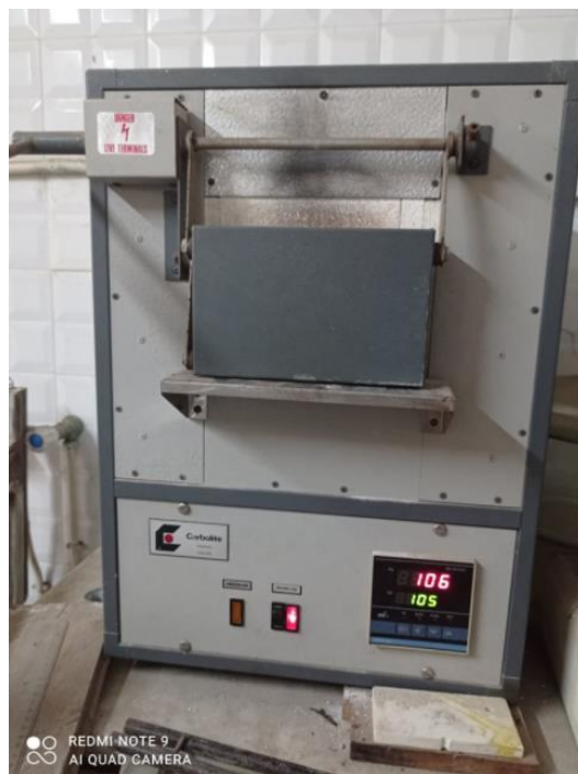
Figure II.16. Étuve utilisé pour le séchage.
