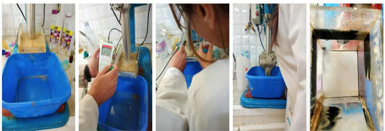
Figure II.25. Le processus de la flottation des micas suivis par une flottation des feldspaths.
