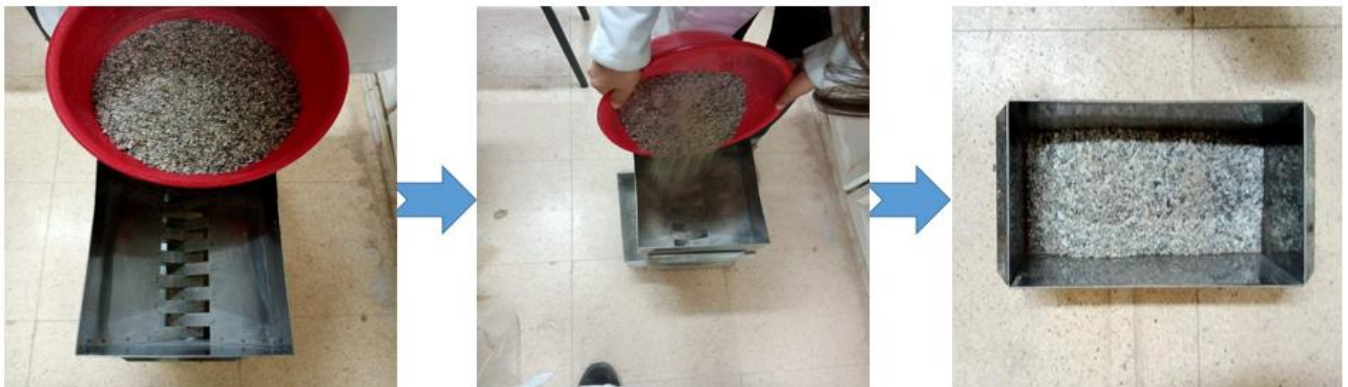
Figure II.7. Diviseur à couloirs.
