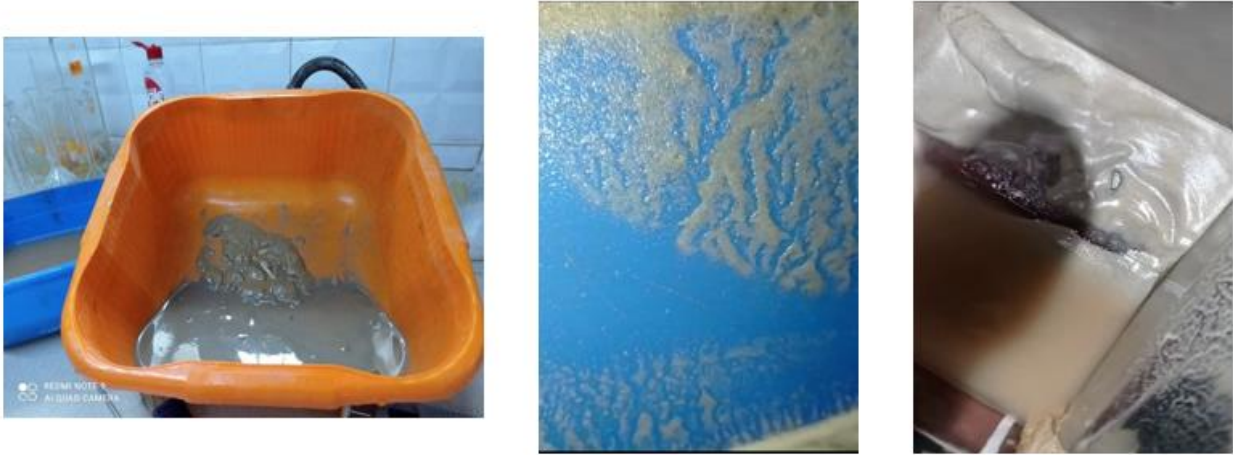
Figure II.29. Le processus de la flottation complète du quartz.
