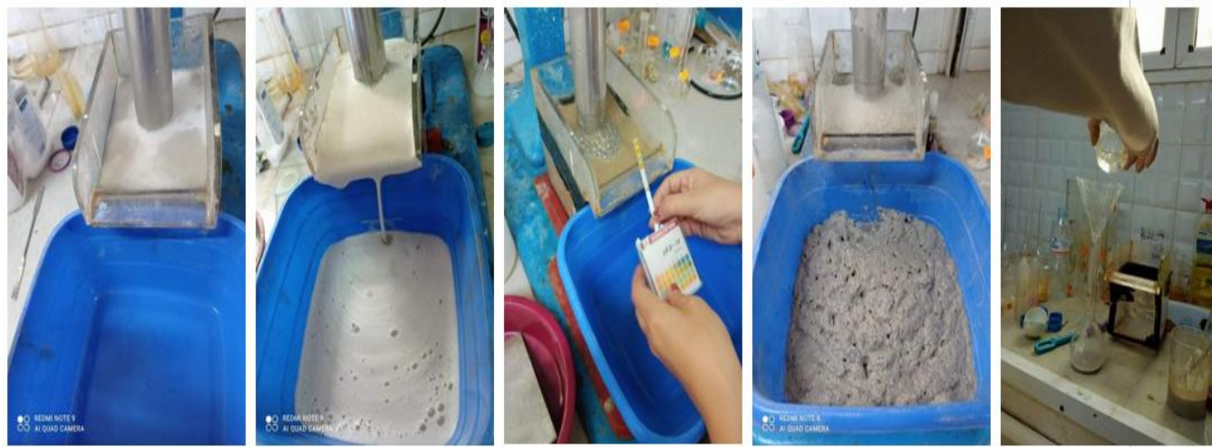
Figure II.33. Processus de la flottation du quartz suivie par une lixiviation chimique.
