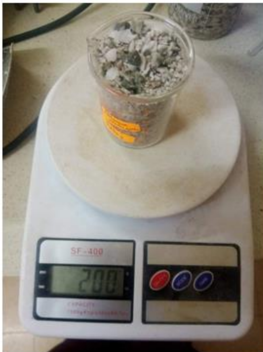
Figure III.9. Mode opératoire pour la détermination de la porosité.
