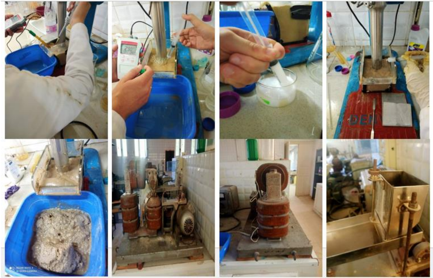
Figure II.22. Processus de la flottation des micas suivi par une séparation magnétique.
