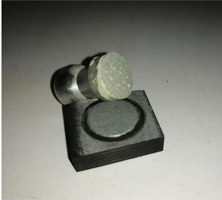
**Figure III.12:** Le plot utilisé pour le test d'adhérence.
