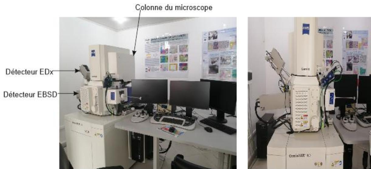
**Figure III.7:** Microscope électronique à balayage (MEB).
