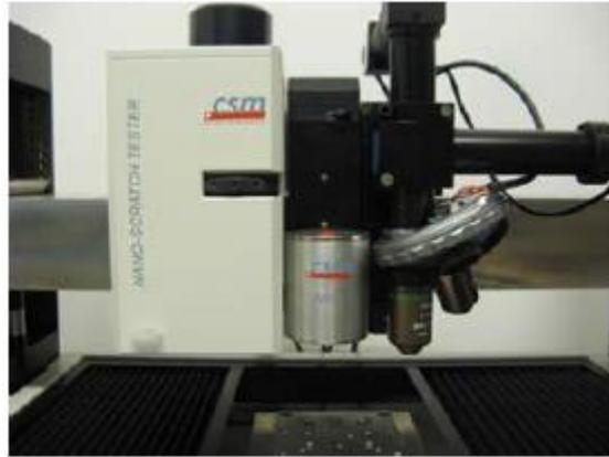
Figure II.7: Appareil de la nano-indentation.
