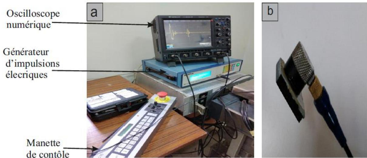
**Figure III.10:** Système de CND par ultrasons. (a): visualisation des résultats du test d'US sur oscilloscope. (b): palpeur-échantillon.
