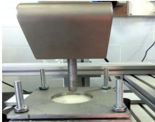
Figure 3.9 : Représentation du dispositif de l'essai d'indentation quasi-statique
