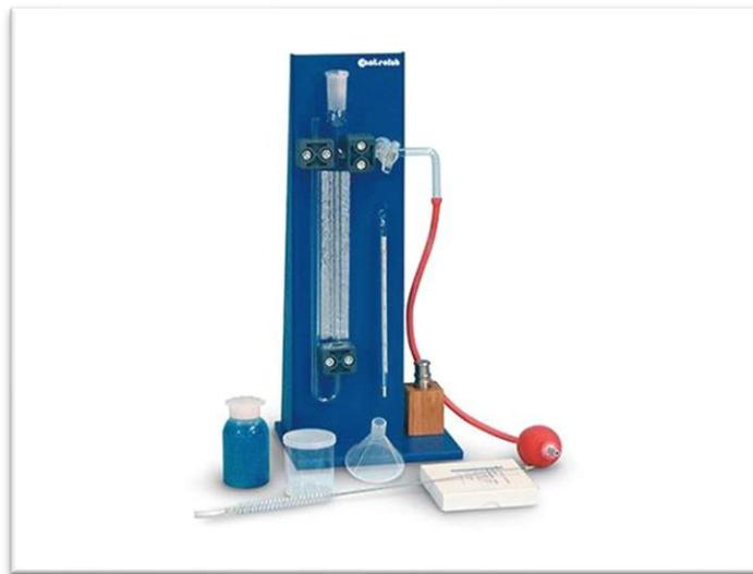
Figure 4.9. Perméabilimètre
