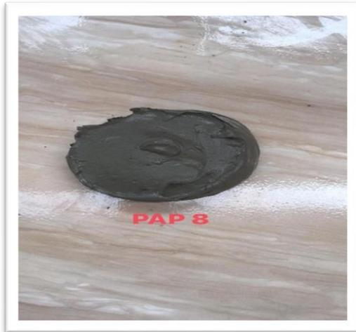
**Figure 5.7. Pâte ferme (essai 08)**
