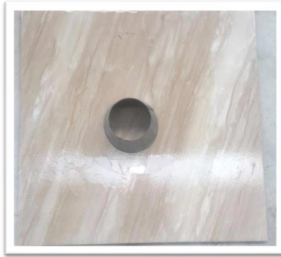
**Figure 4.7. Mini-cône**
