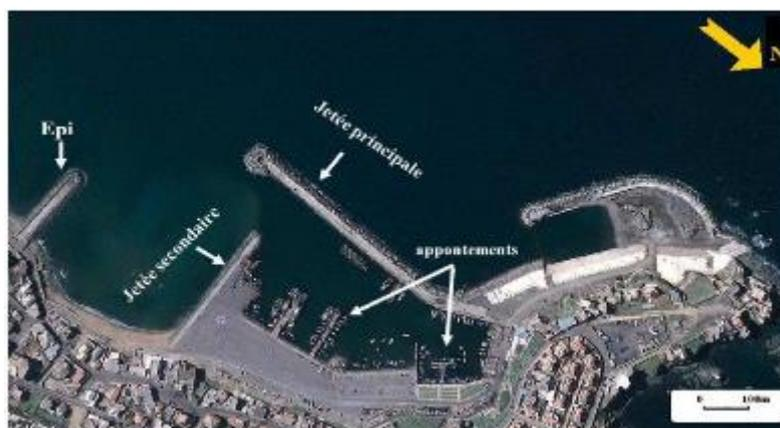
Figure 13 : Jetée principale et secondaire d'un port.
