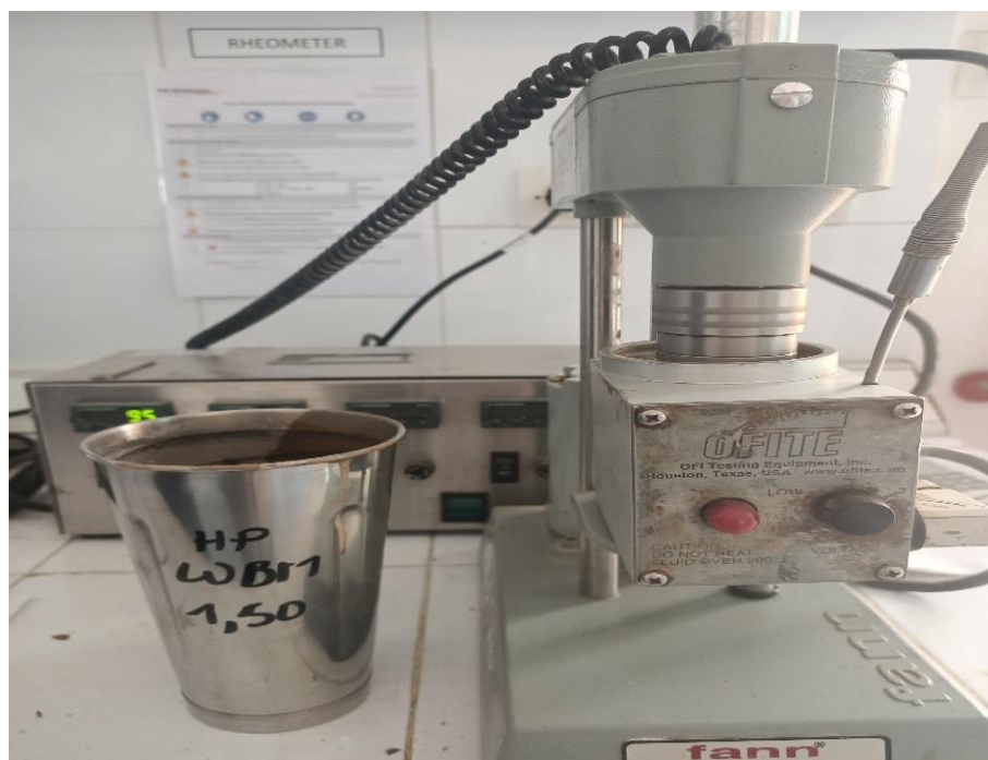
Photo 4-6 : Essai du viscosimètre Funn (TOUNSI & SAHLI, 2021).
