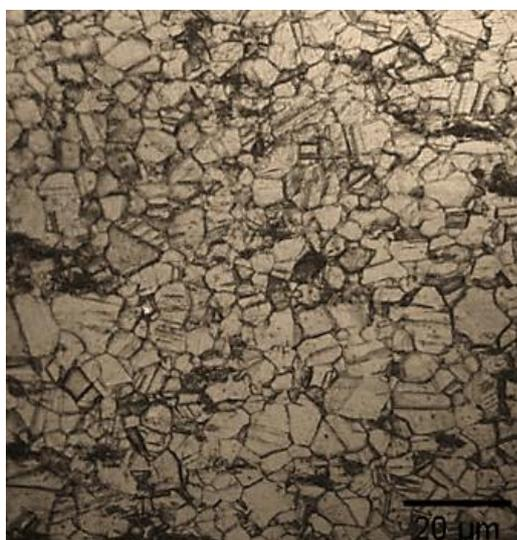
Figure 5-3 Microstructure de l'acier 316L observée au microscope optique.
