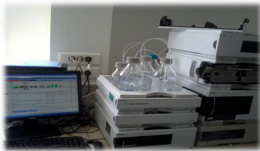
Figure II.2 : Appareil HPLC utilisé pour le dosage des polyphénols.
