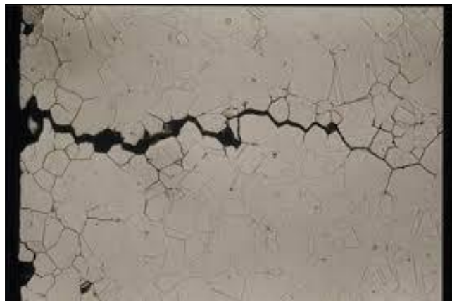
Figure 7 : Forme de la corrosion sous contrainte
