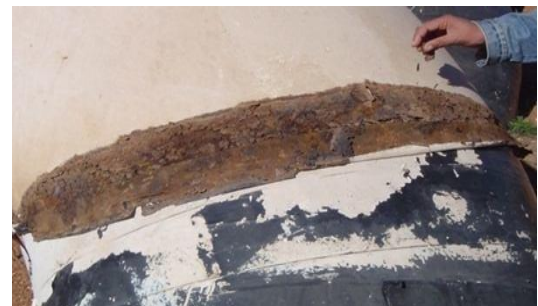
Figure 1-h : Autre type de corrosion
