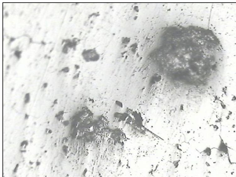
Figure 23 : Piqûration dans l'acier X42 visionné par microscope optique.
