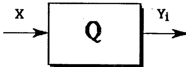
Figure 1.1: Quantificateur type,  $x$  est la grandeur d'entrée à quantifier et  $y_i$  est la valeur de sortie.
