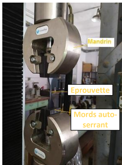
Figure 3.2 Machine universelle de laboratoire mécanique
