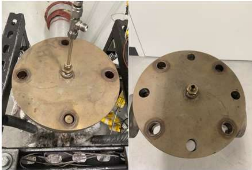
Figure 3. 12 Bride du réacteur avant et après l'ajout des trous.
