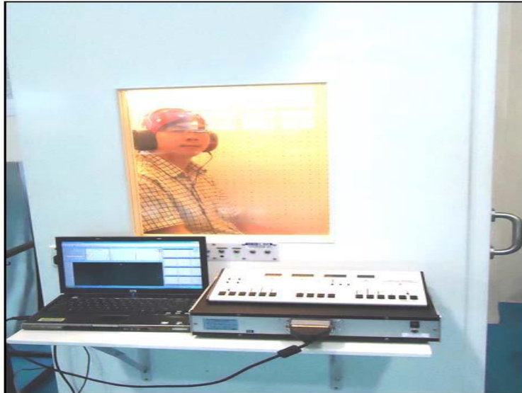
Figure 4.4 : Montage expérimental pour la collecte de données de PEA [2]
