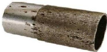
**Figure 2.7 :** Corrosion par piqure d'un acier inoxydable [62].
