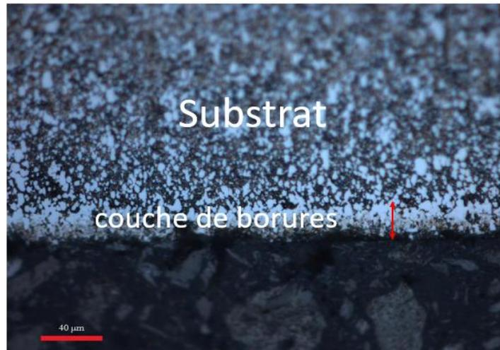
**Figure 3.1** : Micrographie optique de la section droite de la couche borurée de l'acier Z80 traité à 950 °C pendant 1h.
