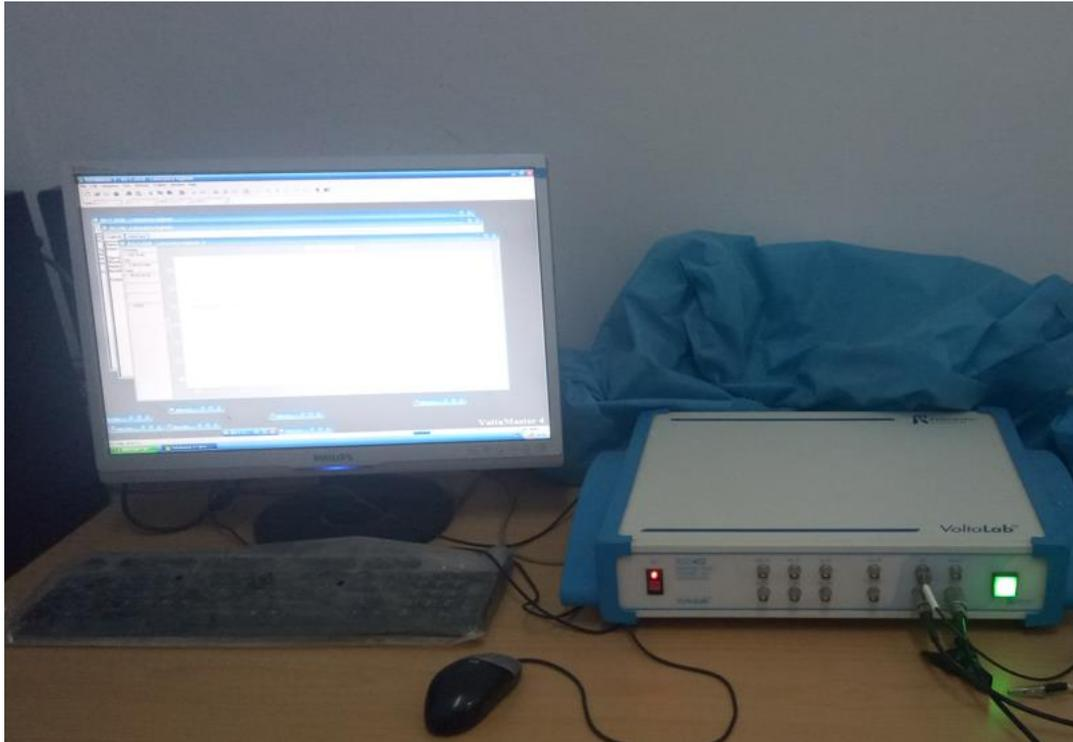
**Figure 4.2** : Spectromètre d'impédance électrochimique VoltaLab. PG.Z 402.
