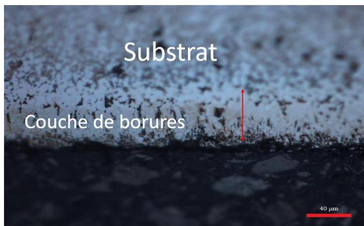
**Figure 3.3** : Micrographie optique de la section droite de la couche borurée de l'acier Z80 traité à 950 °C pendant 8h.
