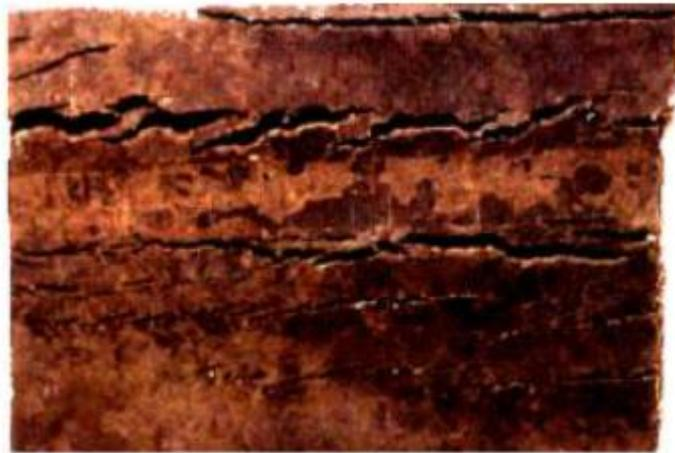
**Figure 2.13** : La corrosion sous contraintes mécaniques [74]
