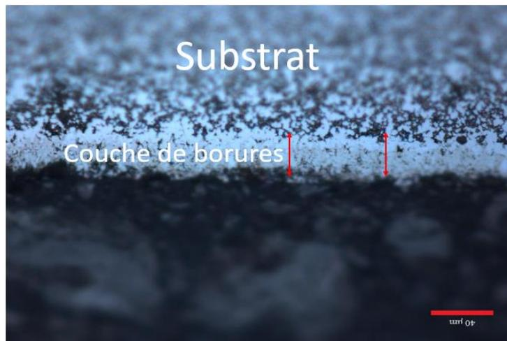
**Figure 3.2** : Micrographie optique de la section droite de la couche borurée de l'acier Z80 traité à 950 °C pendant 2h.
