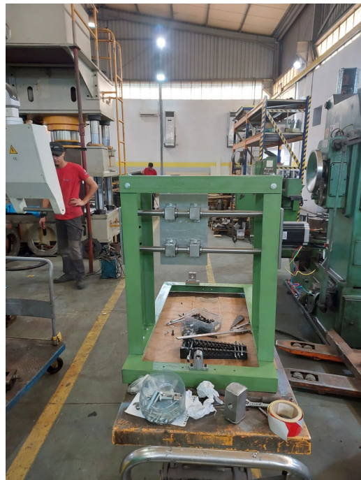
Figure 3-22: installation de l'axe Y
