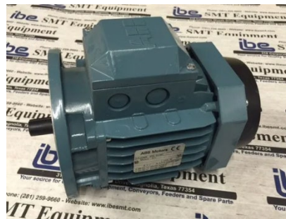
Figure 4-1 le moteur asynchrone ABB 1,1kW de puissance et 3000tr/min de vitesse de rotation
