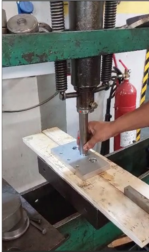
Figure 3-23: Montage du roulement
