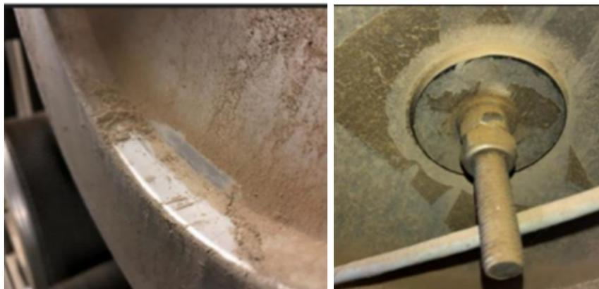
FIGURE 3.3 – Les dépôts de poussière observés sur les faces des cartouches
