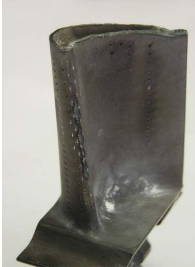
FIGURE 2.2 – Erosion sur le bord d'attaque d'une pale de turbine [3].
