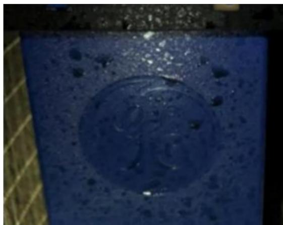
FIGURE 3.6 – Les gouttelettes d'huile déposées sur les filtres
