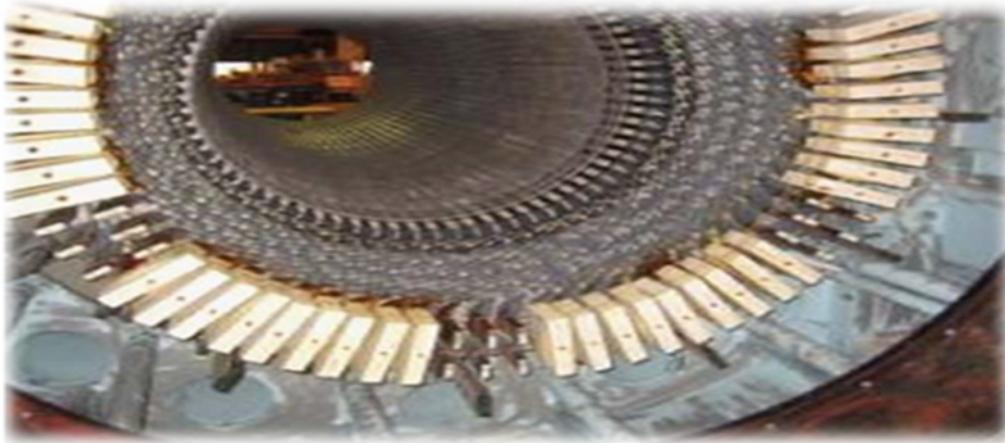
FIGURE 1.8 – Spires terminales de l'enroulement du stator
