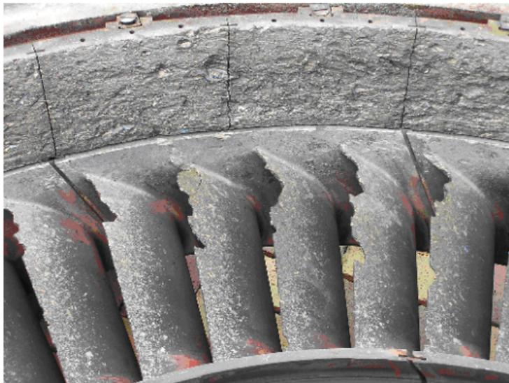
FIGURE 2.1 – Dommages aux turbines à gaz causés par FOD [3].
