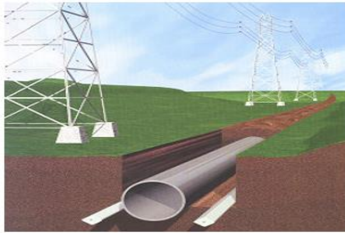
Fig. 2.10. Atténuation de la tension induite par connexion de bandes de Zinc au pipeline
